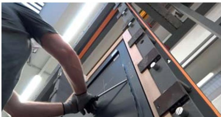
Pour valider le test de résistance RC2, la norme EN 1627-EN 1630 définit un test de 3 min par point de fermeture choisi, durant 15 minutes d'essai maximum, avec les outils de type RC2.
